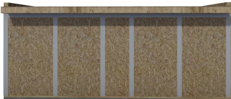
Visus tarpus tarp skydų užklijuokite sandarinimo juosta. Ji turi būti pritvirtinta visose vietose, kuriose susijungia skydai, sienų sujungimuose ir sienų ir stogo sujungimuose.
